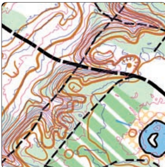
▲ Det digitale grundkort – laserkurver og orthofoto sat sammen. Ækvidstanden er 1,25 meter. De røde har værdien 2,5 – 5 – 7,5 – 10... meter. De blå 1,25 – 3,75 – 6,25... meter. (Vester Thorup Plantage).
